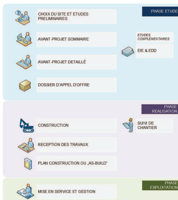
Figure 7 : Étapes d'un projet de réalisation d'un CET [1]
