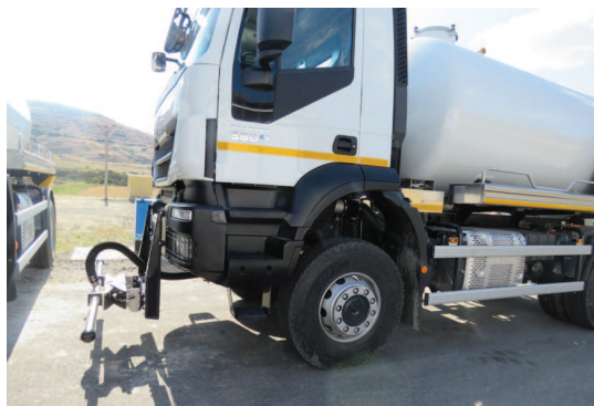
Image 17: camion-citerne avec installation d'arrosage [1]
