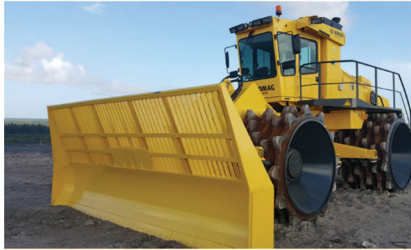
Image 10: Compacteur de déchets [Source Bomag]
